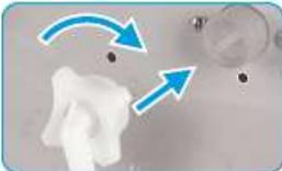
Conecte la manguera de suministro de agua a la válvula de entrada de agua del aparato y a un grifo de agua fría, como se muestra a continuación.
