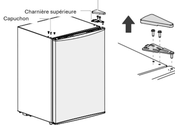
3. Retirez d'abord la porte, puis l'ensemble charnière inférieure et pied de réglage, intervertissez les positions de l'ensemble charnière inférieure et du pied de réglage et installez-les
