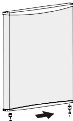
5. Instale la puerta en el conjunto de bisagra inferior y, a continuación, instale las bisagras superiores, la cubierta de la bisagra, los pasadores y la tapa del orificio en secuencia.
