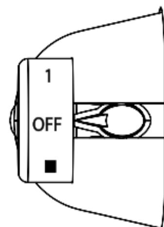
Las cifras no indican la temperatura de ajuste específica, sino el nivel de temperatura.
