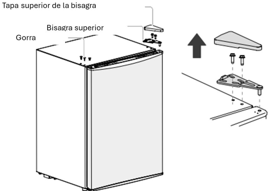
3. En primer lugar, retire la puerta y, a continuación, el conjunto de bisagra inferior y pata niveladora, intercambie las posiciones del conjunto de bisagra inferior y pata niveladora e instálelos.
