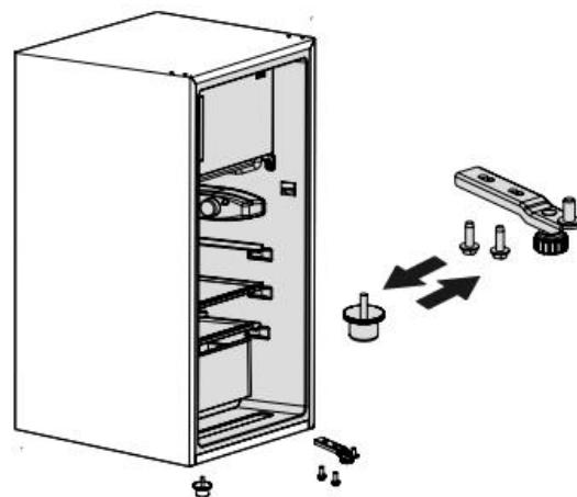
4. Démonter le bouchon sous la porte, puis remonter le bouchon de l'autre côté.
