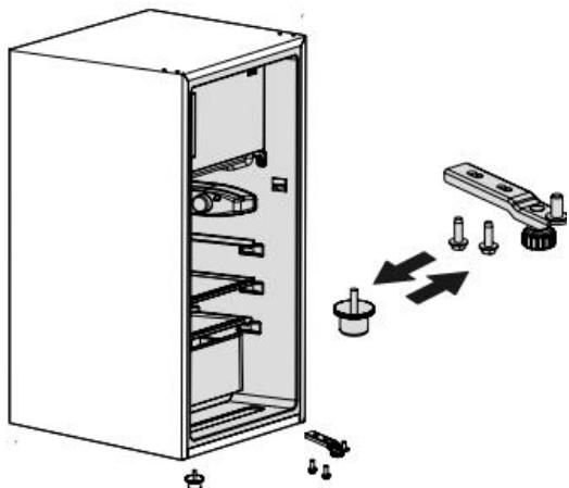
4. Retire el tapón situado debajo de la puerta y vuelva a colocarlo en el otro lado.
