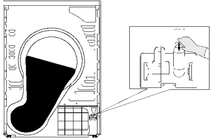
2. Introduzca un extremo del tubo de desagüe suministrado en el conector del tubo.
