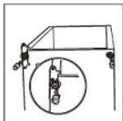
7. Vuelva a colocar la puerta. Compruebe que la puerta queda alineada horizontal y verticalmente de manera que las juntas estén bien cerradas antes de apretar la bisagra superior.
