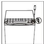
4. Entfernen Sie die unterste Schraube, den Scharnierbügel und die Stellfüße unten am Gerät
