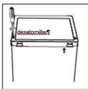
2. Entfernen Sie die obere Adbdeckung.
