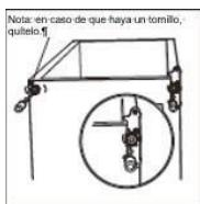
5. Lösen Sie den Scharnierbolzen aus dem Scharnierbügel. Kehren Sie das Scharnier um und befestigen Sie den Scharnierbolzen wieder
