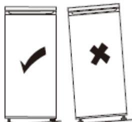
Si el aparato no está correctamente nivelado, las puertas no quedarán bien alineadas y puede que se pierda la hermeticidad de los compartimentos.
