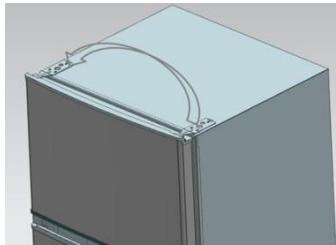
10) Ajuste la posición correcta de la puerta superior y fije la bisagra superior y la tapeta.
