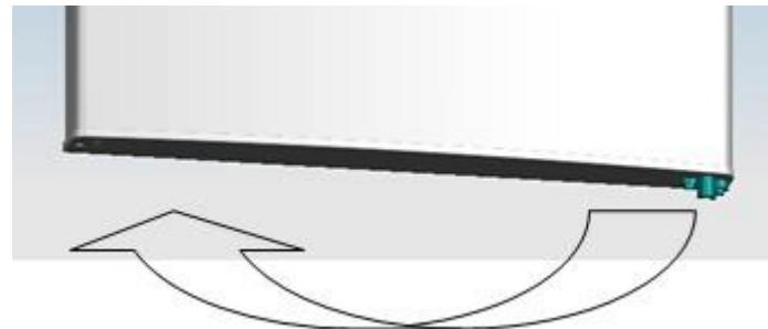
6) Desplace la bisagra inferior al otro lado y fíjela con tornillos.
