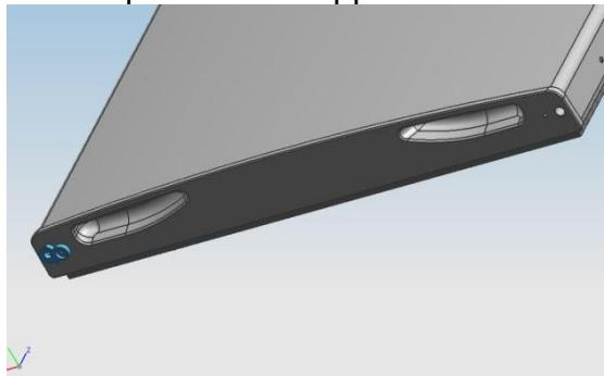
4) À l'aide d'un tournevis cruciforme, desserrez les vis fixées sur la charnière inférieure.
