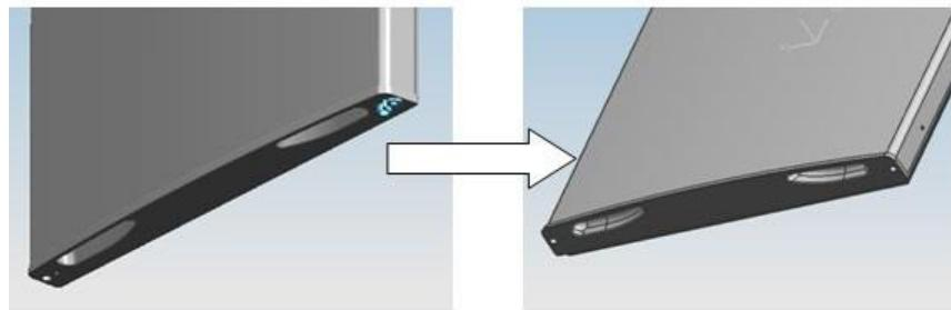
C. Sortez un autre de bloc limite de porte avec support de vis de la porte.
