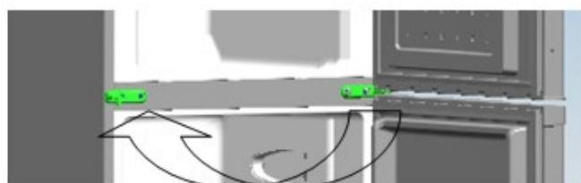
8) Ajuste la posición correcta de la puerta inferior y fíjela la bisagra central.
