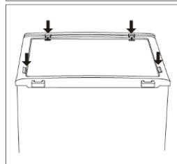
12. Retirez les joints de porte du réfrigérateur et du congélateur, pivotez-les et remettez-les en place.
