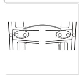
6. Afloje la bisagra inferior. A continuación, retire las patas ajustables de ambos lados.
