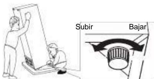
Procedimiento de ajuste de las patas delanteras
