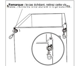
7. Dévissez et retirez la tige de la charnière inférieure, retournez la platine de fixation et remettez-la en place.
