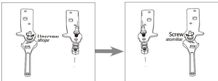
8. Vuelva a fijar el soporte con el pasador de la bisagra inferior. Reemplace las dos patas ajustables. Ponga la puerta inferior en la posición adecuada.
