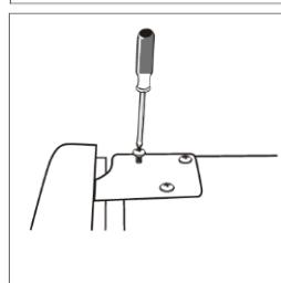
10. Vuelva a colocar la puerta superior. Compruebe que la puerta queda alineada horizontal y verticalmente de manera que la junta esté bien cerrada antes de apretar la bisagra superior. A continuación, introduzca la bisagra y atorníllela en la parte superior del aparato.
