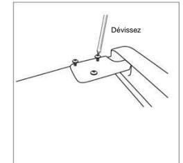
3. Retirez la tige de fixation à l'aide d'un tournevis et retournez la platine de fixation. Replacez ensuite la tige de fixation sur la platine.
