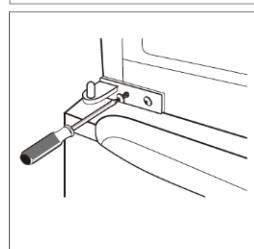
10. Placez la porte supérieure. Assurez-vous que la porte est alignée horizontalement et verticalement de manière à ce que les joints soient fermés de tous les côtés avant de resserrer la charnière supérieure. Insérez ensuite la charnière et vissez-la en haut de l'appareil.
