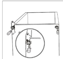
9. Retournez la charnière intermédiaire à 180°, puis placez-la du côté gauche. Placez la tige de fixation de la charnière intermédiaire dans l'orifice situé en haut de la porte inférieure, puis serrez les boulons.
