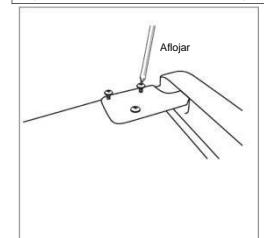
3. Quite el pasador con un destornillador y tire del soporte de la bisagra. Vuelva a colocar el pasador en el soporte de la bisagra.
