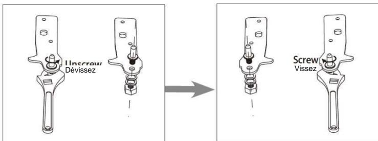
8. Replacez la platine de fixation équipée de la tige de la charnière inférieure. Replacez les deux pieds réglables. Remettez la porte inférieure en place.
