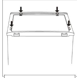
11. Coloque la cubierta superior y fíjela con 2 tornillos en la parte trasera.
