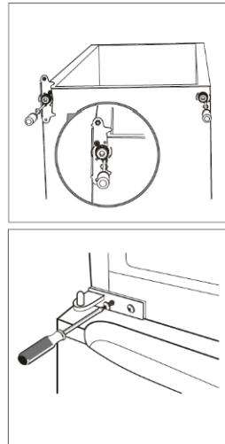
9. Invierta 180 °C la bisagra central y luego pásela a la posición adecuada. Ponga el pasador de la bisagra central en el orificio superior de la puerta inferior y apriete los pernos.
