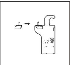
2. Remova a tampa superior esquerda do parafuso.
