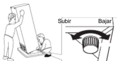
Procedimiento de ajuste de las patas delanteras
