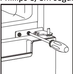
4. Ao deitar o aparelho, remova os pés de ajuste como mostra abaixo, em seguida, remova a dobradiça inferior usando uma chave de fenda Phillips.
