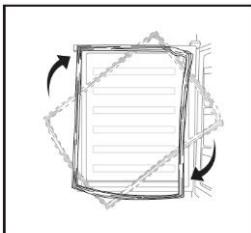
8. Retire os batentes originais das portas superior e inferior e, em seguida, instale os batentes das portas fornecidas no saco acessório (com instruções de utilização) no lado oposto.
