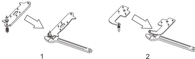
6. Instale a dobradiça inferior sob o aparelho, conforme mostrado abaixo. Aparafuse os pés de ajuste, verificando a posição horizontal.
