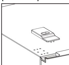
3. Remova a porta superior, remova o parafuso da dobradiça do meio usando uma chave de fenda Phillips e, em seguida, remova a porta inferior.
