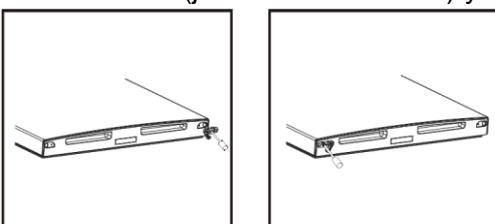
9. Instale la puerta inferior, ajuste y fije la bisagra central en el mueble.
