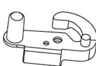
1. Suelte el embellecedor de la bisagra superior y desatornille la bisagra superior.
