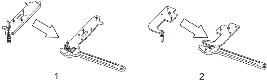
6. Installez la charnière inférieure sous le réfrigérateur, comme présenté ci-dessous. Vissez les pieds de réglage en vérifiant la position horizontale.
