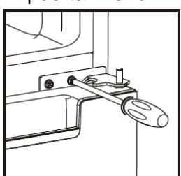
4. Al instalar el frigorífico, retire las bases de ajuste como se indica a continuación y retire la bisagra inferior con un destornillador de estrella.
