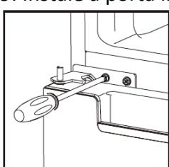
10. Coloque a porta superior. Certifique-se de que a porta esteja alinhada horizontal e verticalmente para que as vedações sejam fechadas em todos os lados antes de apertar a dobradiça superior. Em seguida, segure a dobradiça superior no lugar e parafuse-a na parte superior do dispositivo. Por fim, prenda a tampa da dobradiça (localizada no saco acessório) usando o parafuso.
