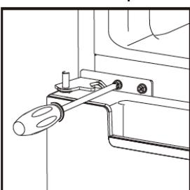
10. Placez la porte supérieure. Assurez-vous que la porte est alignée horizontalement et verticalement de manière à ce que les joints soient fermés de tous les côtés avant de resserrer la charnière supérieure. Puis maintenez la charnière supérieure en place et vissez-la au sommet de l'appareil. Enfin, fixez le cache-charnière (situé dans le sachet d'accessoires) à l'aide de la vis.
