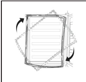
8. Retirez les butées d'origine des portes supérieure et inférieure, puis installez les butées de porte fournies dans le sac d'accessoires (avec les modes d'emploi) sur le côté opposé.
