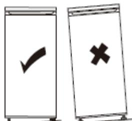
Si l'appareil n'est pas à niveau, les portes ne seront pas correctement alignées et l'étanchéité des compartiments peut ne pas être assurée.
