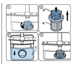
Para extraer y limpiar los filtros, gire el filtro b en sentido contrario a las agujas del reloj y retírelo levantándolo (1). Separe el filtro grande del microfiltro (2). Tire del filtro metálico y extráigalo (3). Enjuague los filtros con abundante agua hasta que no queden residuos. Vuelva a colocar los filtros juntos. Vuelva a colocar el conjunto del filtro y gírelo en el sentido de las agujas del reloj (4).
