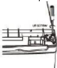
4. Retire los tornillos y la bisagra inferior. Luego retire las patas ajustables de ambos lados:
