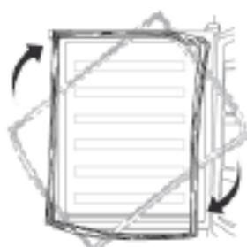
8. Vuelva a colocar la puerta. Asegúrese de que la puerta esté alineada horizontal y verticalmente de modo que las juntas estén cerradas por todos los lados antes de apretar la bisagra superior:
