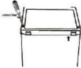
2. Levante con cuidado la cubierta superior 5 cm del congelador y luego retire el terminal. Quite la cubierta superior.
