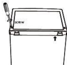
11. Lorsqu'elle est fermée, vérifiez que la porte est alignée horizontalement et verticalement et que les joints sont fermés de tous les côtés avant de resserrer la charnière inférieure. Réajustez les pieds de mise à niveau si nécessaire
