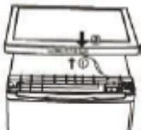
3. Quite los tres tornillos y luego la bisagra superior que sostiene la puerta. Levante la puerta y colóquela sobre una superficie acolchada para evitar rayarla:
