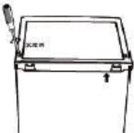
11. Cuando la puerta esté cerrada, verifique que esté alineada horizontal y verticalmente y que las juntas estén cerradas por todos los lados antes de apretar la bisagra inferior. Reajuste las patas de nivelación en caso necesario.
