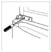
10. Vuelva a colocar la puerta superior. Compruebe que la puerta queda alineada horizontal y verticalmente de manera que la junta esté bien cerrada antes de apretar la bisagra superior: Luego inserte la bisagra y fíjela en la parte superior del aparato.
