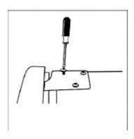
11. Coloque la cubierta superior y atorníllela en la parte trasera.
